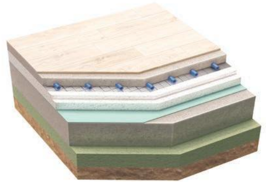
Schema Fußboden Erdgeschoss
