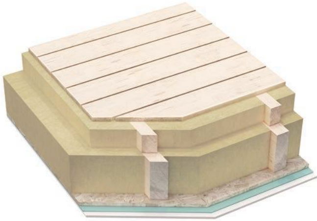
Aufbau der Kehlbalckendecke zum unbeheizten Spitzboden
